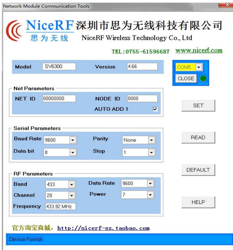
在模块正常连接后，模块便处于“可设置参数”的状态。用户可以通过 PC 界面修改模块的相关参数，如：工作频段、收发信道，空中通信速率，发射功率；串口波特率、数据位、停止位、奇偶效验位；NET ID, NODE ID 等，然后点击【SET】按钮对模块进行设置，每次参数成功改变后都会回传“OK”信息，PC 软件收到 OK 的回应后需弹出成功操作的提示对话框；否则输出“ERROR”，弹出操作错误的对话框，如 PC 发送指令之后 0.5s 内没有任何响应，则发生通讯错误，亦弹出操作错误的对话框。这些设置后的参数掉电均可保存。用户点击【READ】的按钮，模块将返回当前模块的所有参数信息。用户点击【DEFAULT】按钮将模块的参数设置为出厂默认值。（上述 PC 界面中的串口以及无线部分的相关参数即为出厂默认值）
