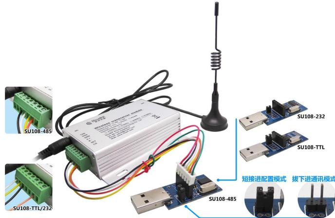
注：此模块为大功率模块，如用转接板连接 PC 端串口收发数据需要额外给模块提供电源。
